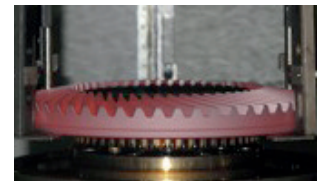
Automatische Beladung einer Härtevorrichtung
