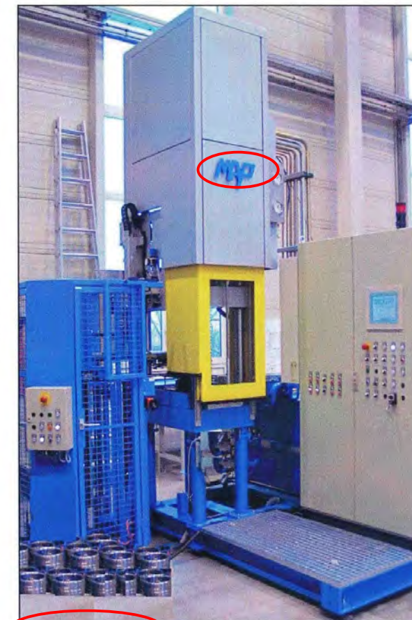
MAP Dornhärtemaschine DHM 1-350 S bei der Inbetriebnahme im Werk
